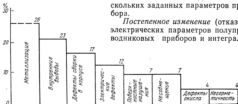
Рис. 8.2. Распределение отказов приборов по причинам, их вызывающим
